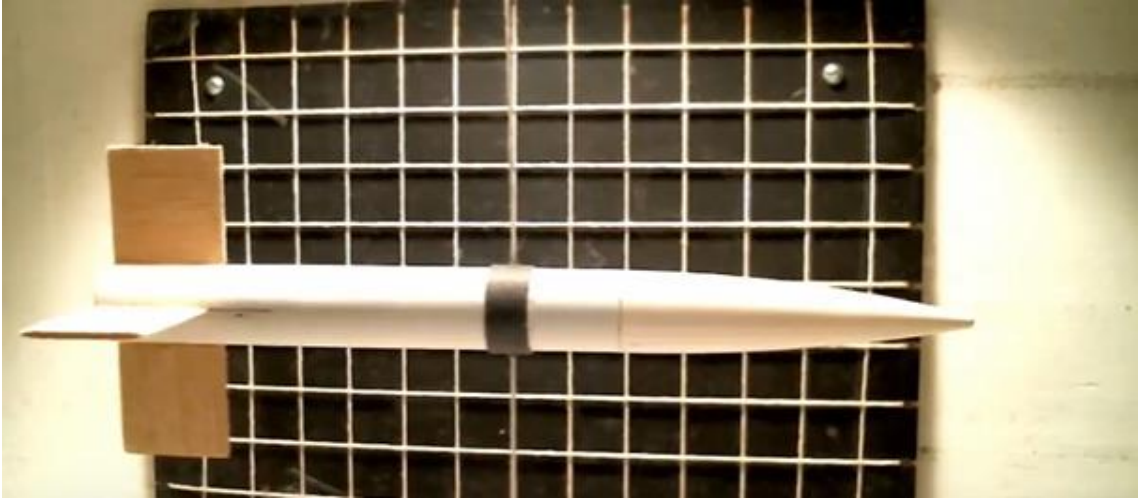
Şekil 51: Rüzgâr Tüneli Testine Sokulmuş Model Roket [7]
