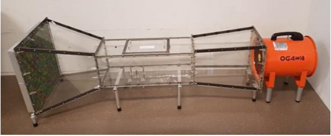
Şekil 50: Küçük Ölçekli Subsonik Rüzgâr Tüneli Test Düzeneği [6]
