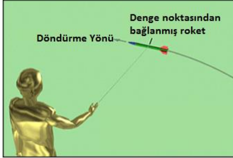
Şekil 45: Model Roket için Kararlılık Testi [3]
